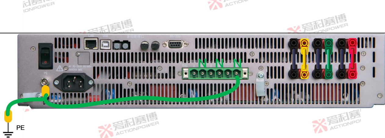
图 22 输出中点接地示意图
