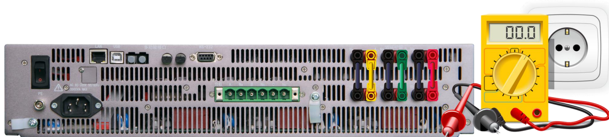
图 1 断开交流电源后的交流输入滤波器剩余电压检查示意图
