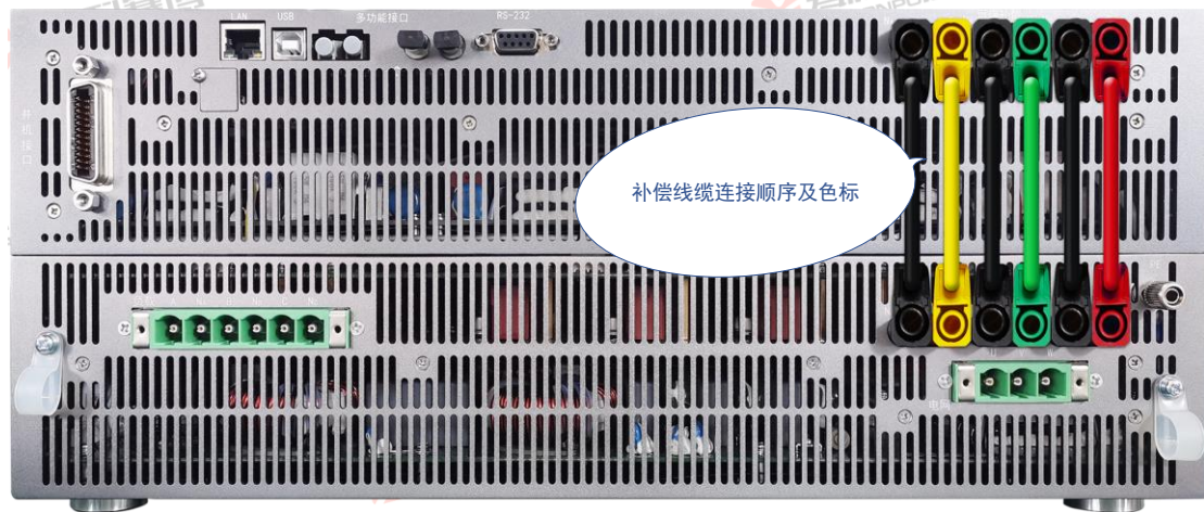
图 93 补偿线缆连接顺序及色标
