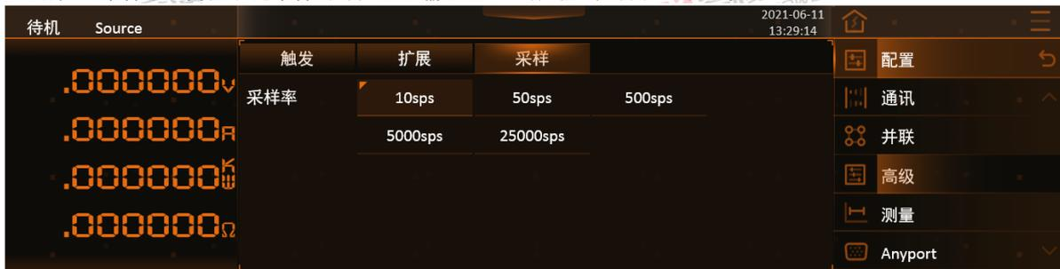
图 205 配置-高级-采样界面图
