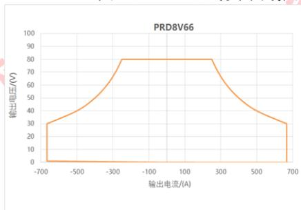
图 31 PRD8V66 功率曲线图
