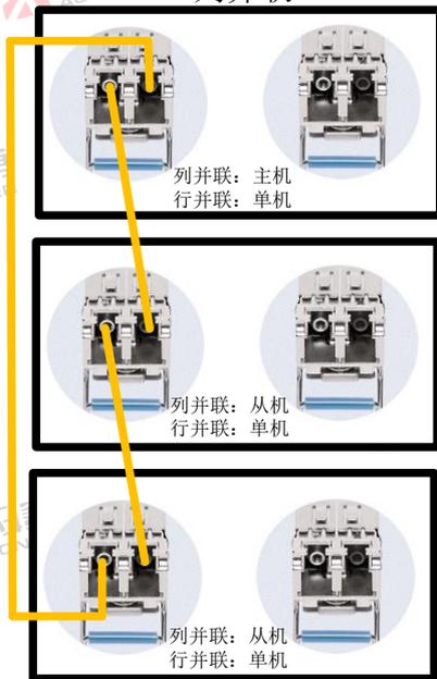
图 194 列并联光纤连接示意图
