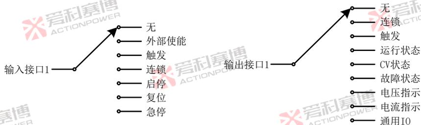
图 86 Anyport 输入、输出接口功能示意图
