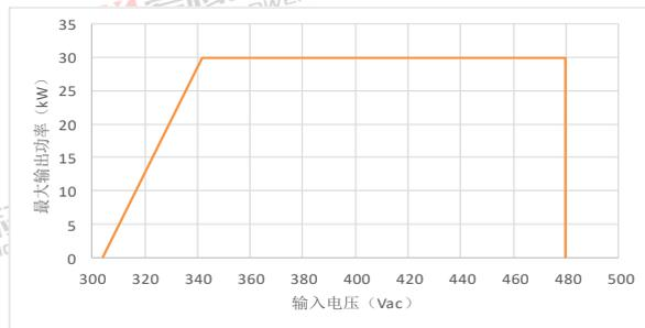
图 66 功率-输入电压曲线图
