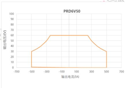
图 33 PRD6V50 功率曲线图
