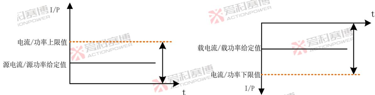
图 185 电流、功率限值示意图
