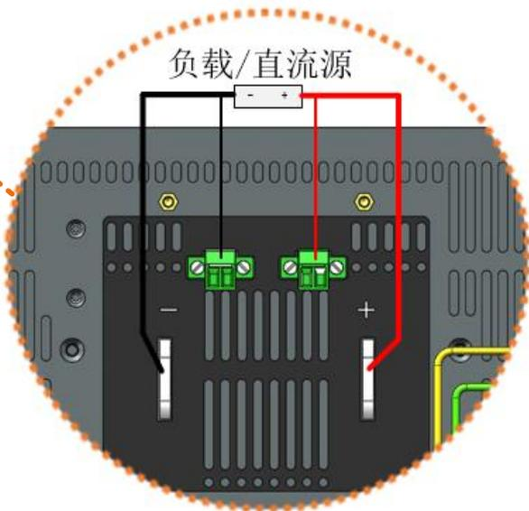
图 76 远端补偿连接示意图
