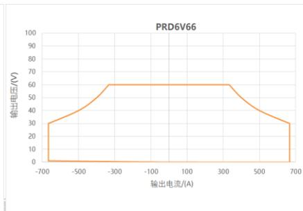
图 30 PRD6V66 功率曲线图
