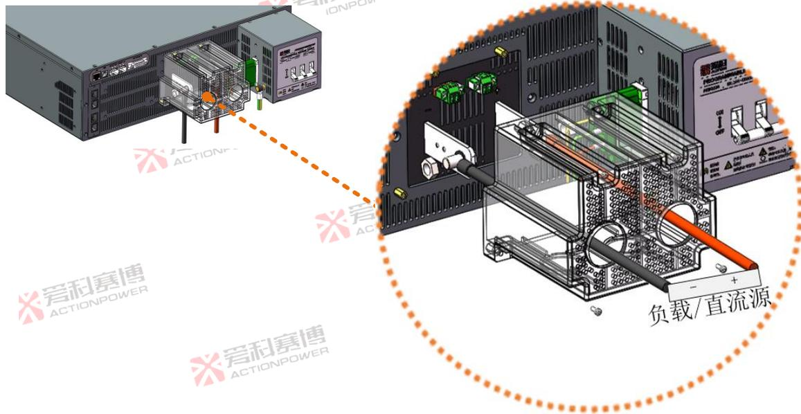
图 74 输出端安装示意图
