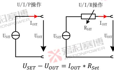
图 98 源模式下恒阻模式电路原理图
