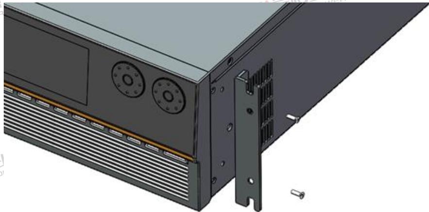
图 68 挂耳安装示意图
