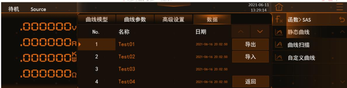
图 158 函数-SAS-静态曲线-数据-USB 界面图
