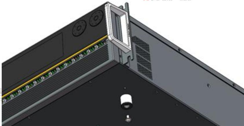
图 70 脚垫安装示意图
