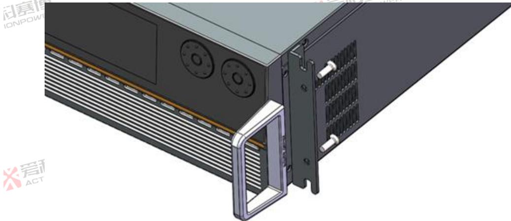
图 69 拉手安装示意图
