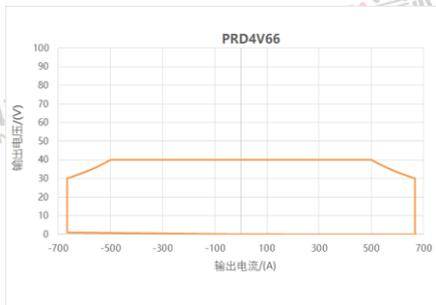
图 29 PRD4V66 功率曲线图
