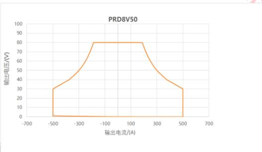
图 34 PRD8V50 功率曲线图
