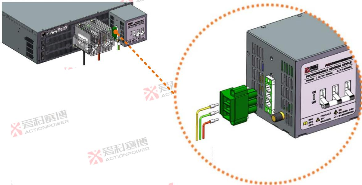
图 71 交流端接线方式示意图
