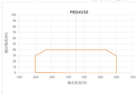
图 32 PRD4V50 功率曲线图
