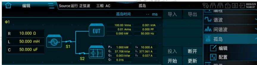
图 126 RLC 模式防孤岛测试界面图二
