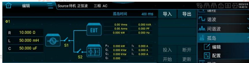
图 128 RLC 模式防孤岛测试界面图四
