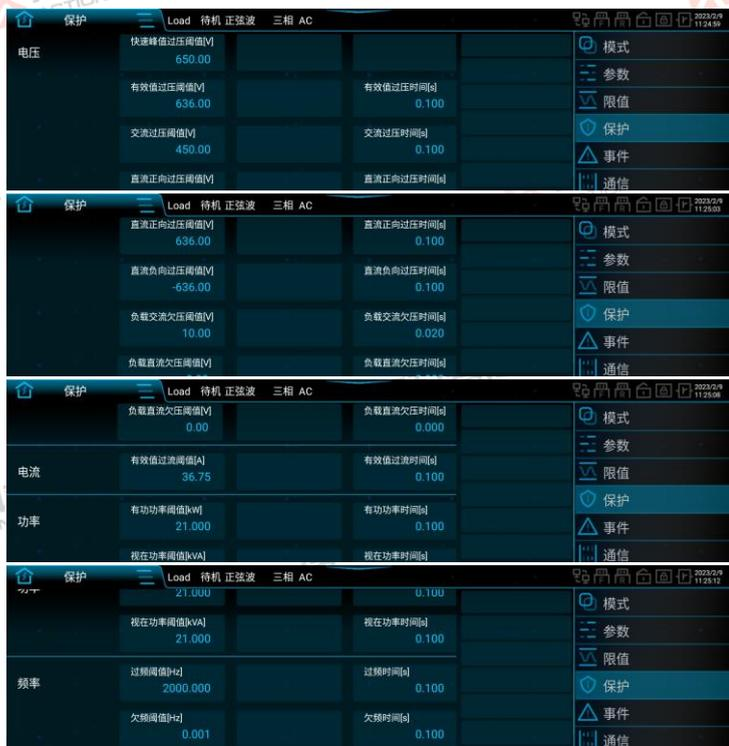
图 179 负载模式保护设置界面图
