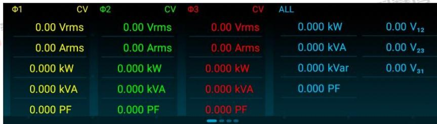
图 53 输出基本参数显示页面图
