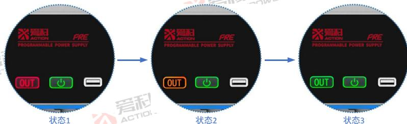
图 39 输出断开延时状态图
