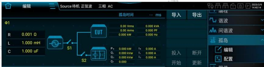
图 121 RLC 模式参数设置界面图
