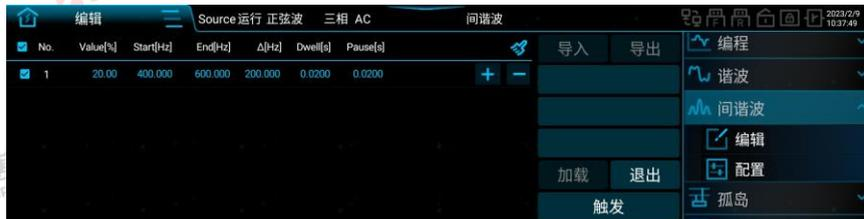
图 117 间谐波参数设置示例图二
