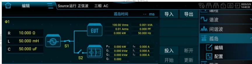
图 125 RLC 模式防孤岛测试界面图一
