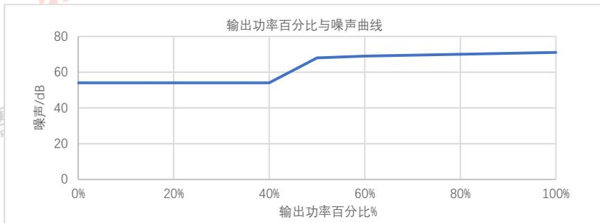
图 18 输出功率与噪声曲线图
