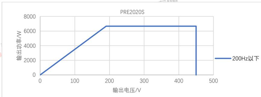
图 11 PRE2020S 三相模式下单相输出电压与输出功率曲线图
