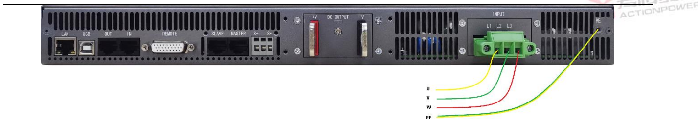
图 10 输入接线示意图
