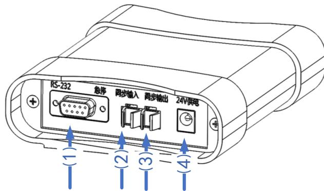
图 87 触发终端后面板功能划分
