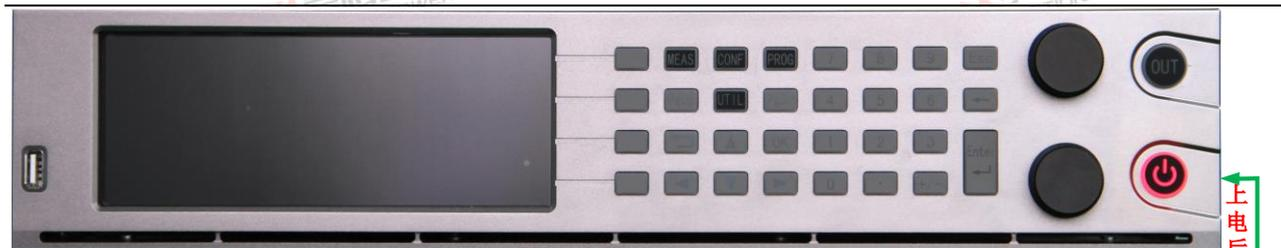
图 30 开机/关机/复位按钮-待机状态
