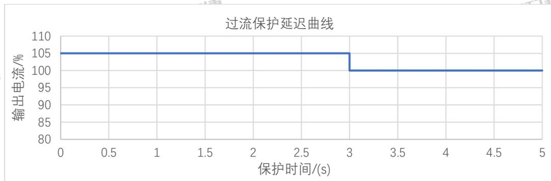
图 16 过流保护延迟曲线
