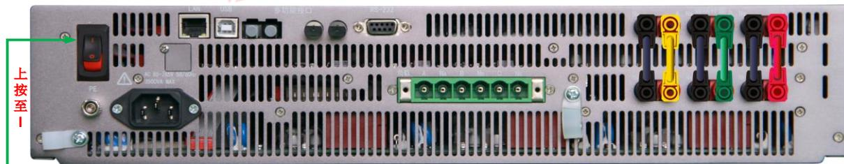
图 29 输入开关-开机状态
