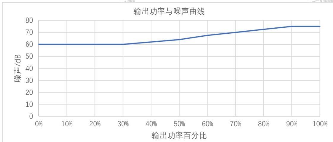
图 19 输出功率与噪声曲线
