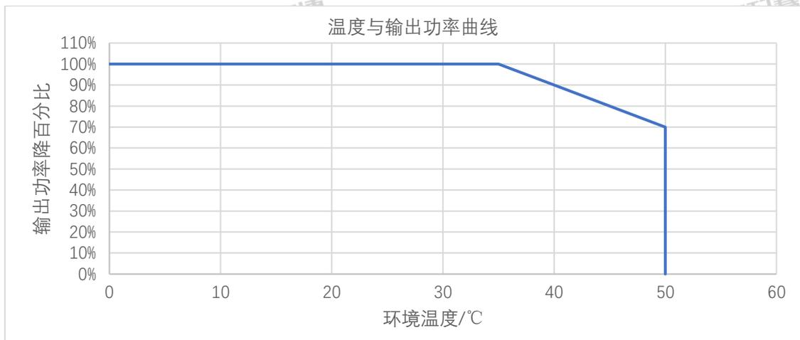
图 17 温度与输出功率曲线
