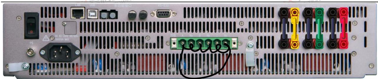
图 58 校准电压零偏接线示意图
