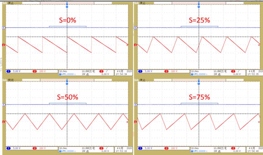
图 48 三角波对称度波形示例
