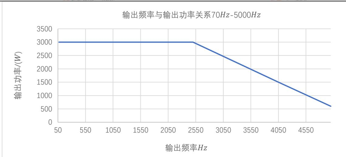
图 11 输出频率与输出功率关系 70Hz-5000Hz
