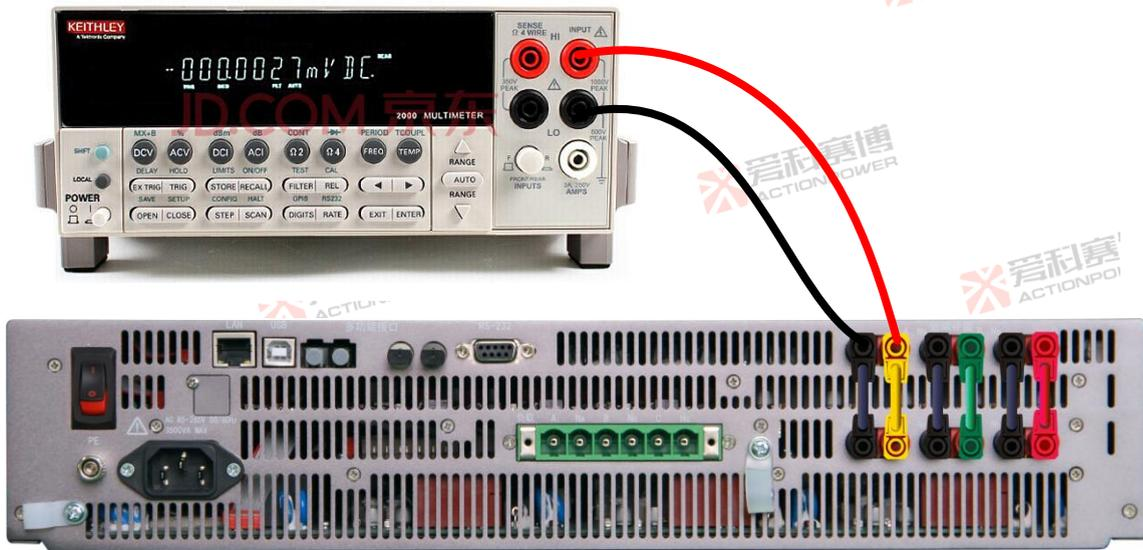
图 59 校准电压增益接线示意图
