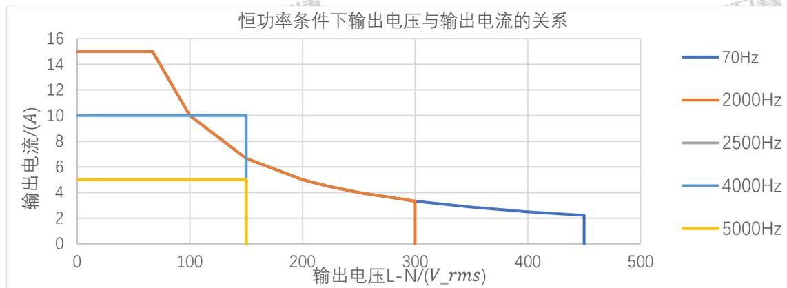
图 9 PAC0315 恒功率条件下输出电压与输出电流的关系
