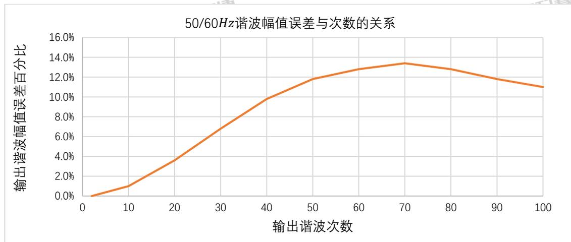
图 12 50/60Hz谐波幅值误差与次数的关系
