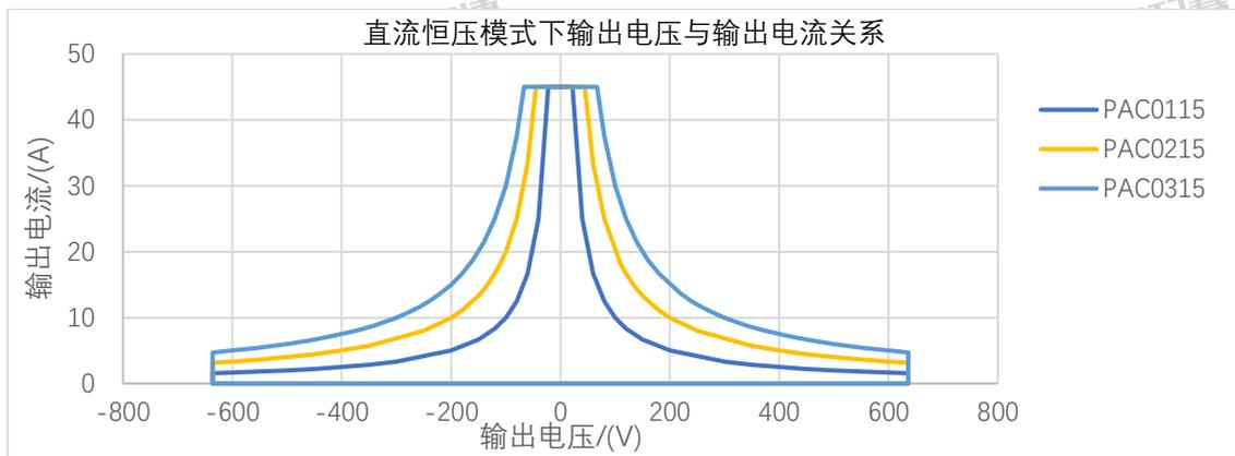
图 14 直流恒压模式下输出电压与输出电流关系
