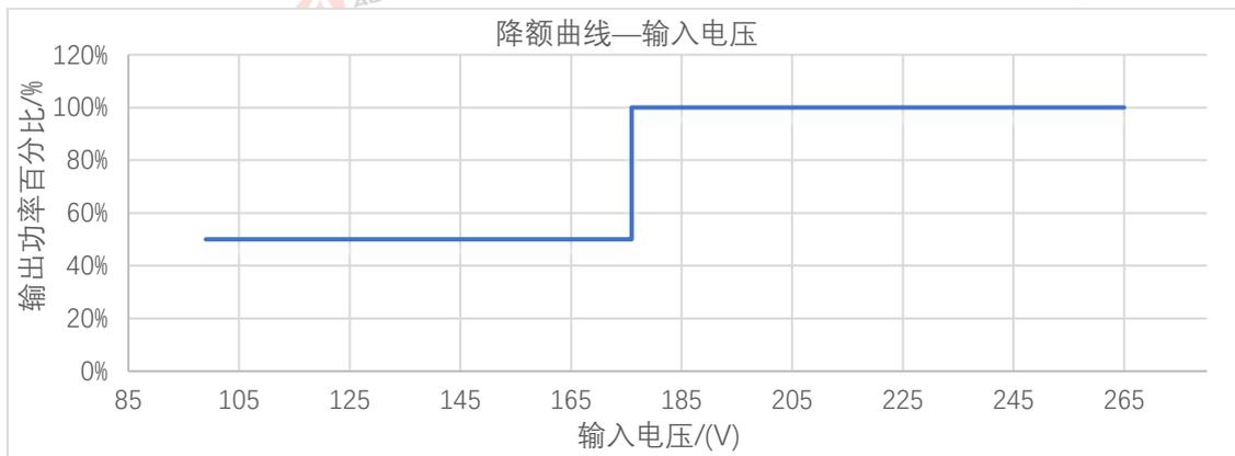
图 15 降额曲线—输入电压
