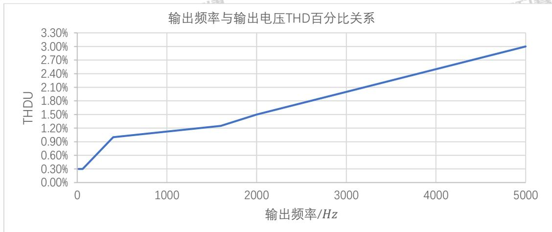
图 8 输出频率与输出电压 THD 百分比关系
