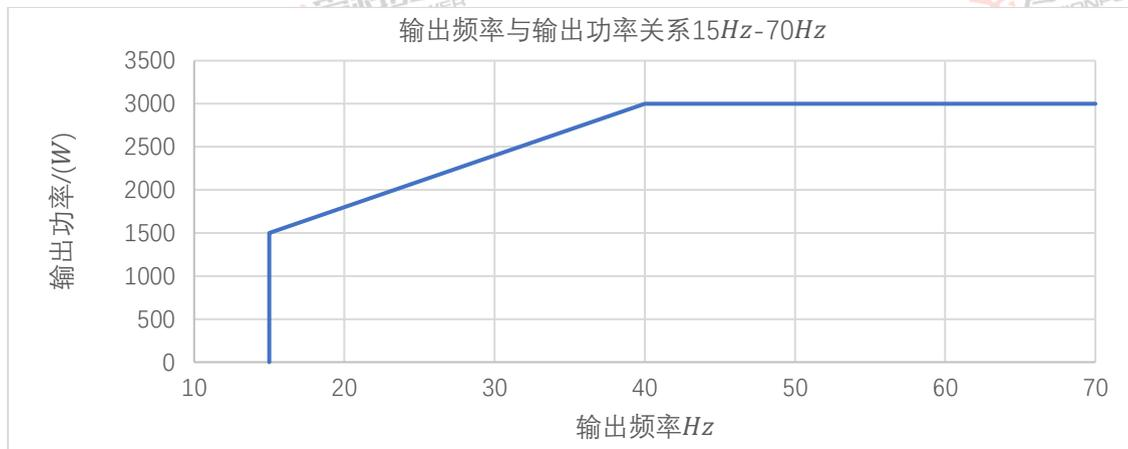
图 10 输出频率与输出功率关系 15Hz-70Hz
