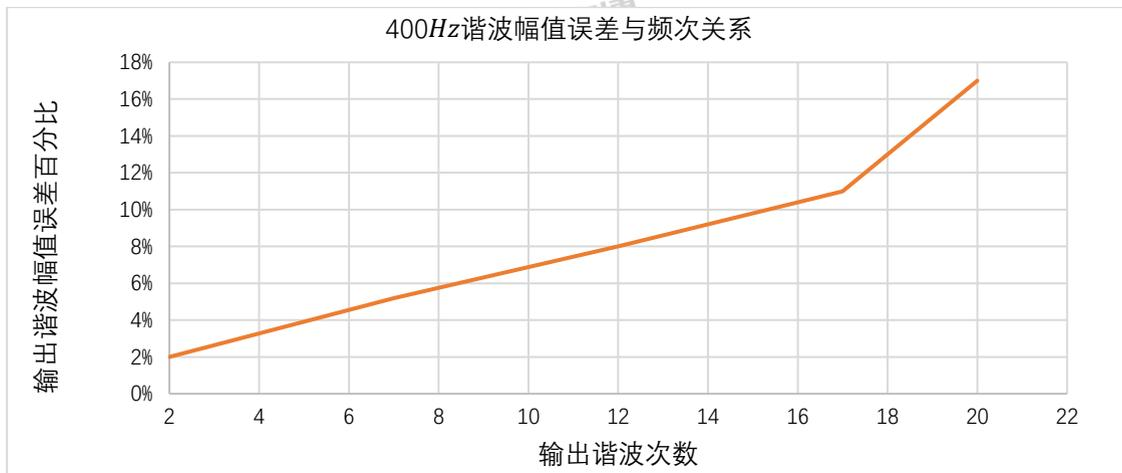
图 13 400Hz谐波幅值误差与频次关系
